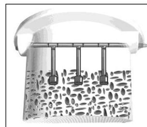
Временная работа мешалки позволяет поддерживать оптимальное разбавление продукта.
